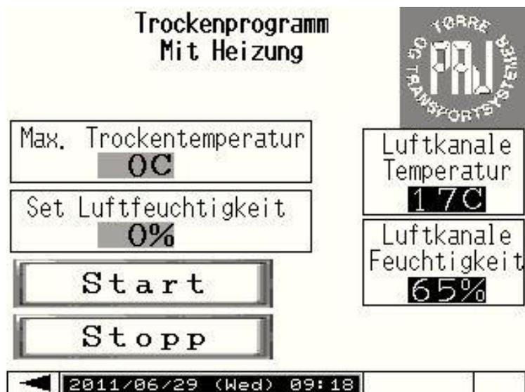
Max. Trockentemperatur und gewünschte Luftfeuchtigkeit einstellen
